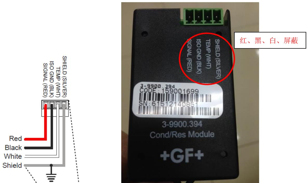
2818、2819、2839 不建议接延长线，其它型号**电缆最大**可延长至**30 米**，建议使用屏蔽线，和动力线分开走，**屏蔽线一定要接**，远离泵。
